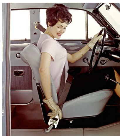
Der Volvo „Amazon“ und der Volvo PV544 „Buckel“ waren die ersten Fahrzeuge mit serienmäßigem Dreipunkt-Sicherheitsgurt.
